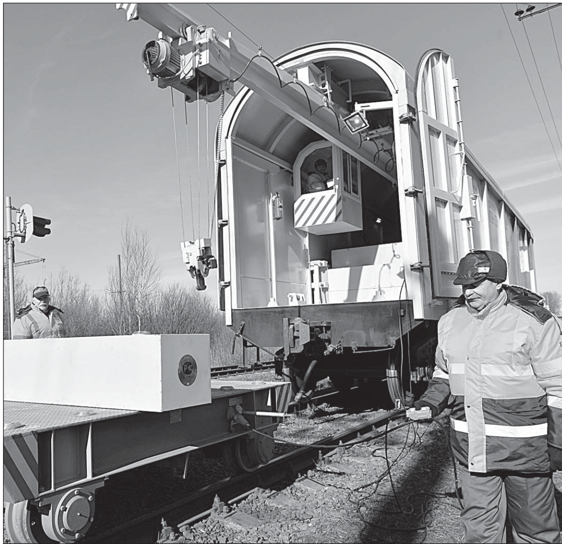
С помощью таких спецвагонов проверяют настройку больших грузовых весов
