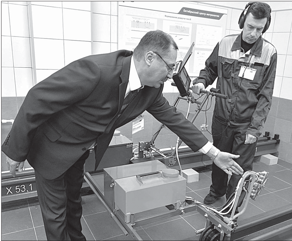
Так проходят испытания ультразвукового дефектоскопа, который выявляет трещины и дефекты в рельсах
