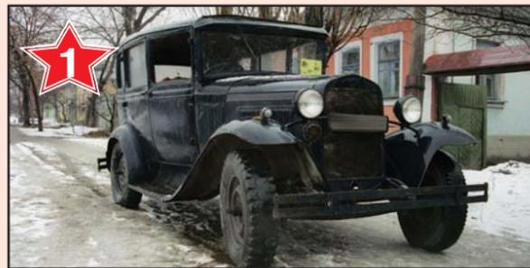
ПЕРВЫЙ советский легковой автомобиль с закрытым кузовом массовой конвейерной сборки производили на Горьковском автозаводе с 1932-го по 1936-й. Причем пятиместная четырехдверная машина являлась лицензионной копией «Ford-A». Рамная конструкция, трехступенчатая коробка передач... Разогнался ГАЗ-А до 90 км в час, но бороздил просторы СССР недолго. Уже в 1936-м всем его владельцам было предписано сдать ГАЗ-А государству и приобрести с доплатой его «наследника» - ГАЗ-М-1.
