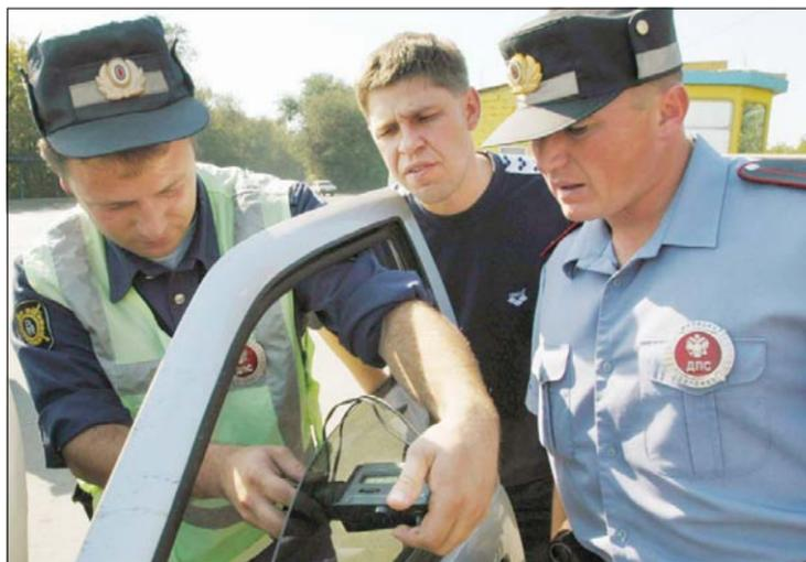
Уровень светопропускаемости проверяют специальным аппаратом
