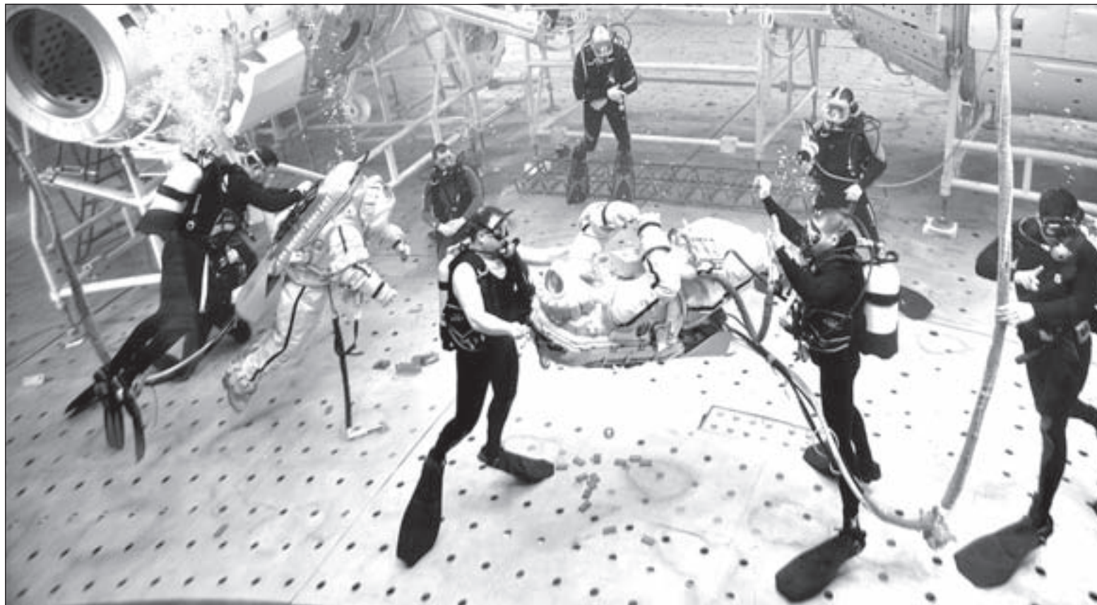
Испытатели проверяют под водой скафандры, пришедшие с завода после ремонта
